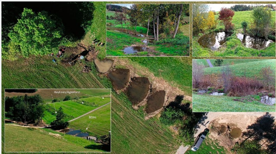
Fig. 8 SWL-Projekt auf der Horbermatt in Oberbalm BE mit 30 künstlichen Biberdämmen (BDA) und Agroforst. Vor den Massnahmen hatte sich der steile Bachlauf stellenweise um 2 m abgetieft und entwässerte und erodierte das Kulturland permanent. Dank der angehobenen Bachsohle und der Abflussverzögerung konnten Wasserhaushalt und Bodenfeuchte regeneriert und auch neue Lebensräume geschaffen werden. (© SRF, Emch+Berger, Horbermatt)
