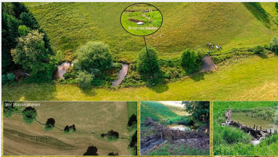
Fig. 7 SWL-Projekt am Schlossbach, Rümligen BE, vor Massnahmen (eingetieftes Gerinne unten links) und nach dem Einbau von sechs künstlichen Biberdämmen (BDA). Neben der hydrologischen Verbesserung (Anreicherung Grundwasser, Resilienz für lokale Trinkwasserfassung) konnte auch eine deutliche ökologische Aufwertung erzielt werden [37]. (© C. Angst, Emch+Berger, Swisstopo)
