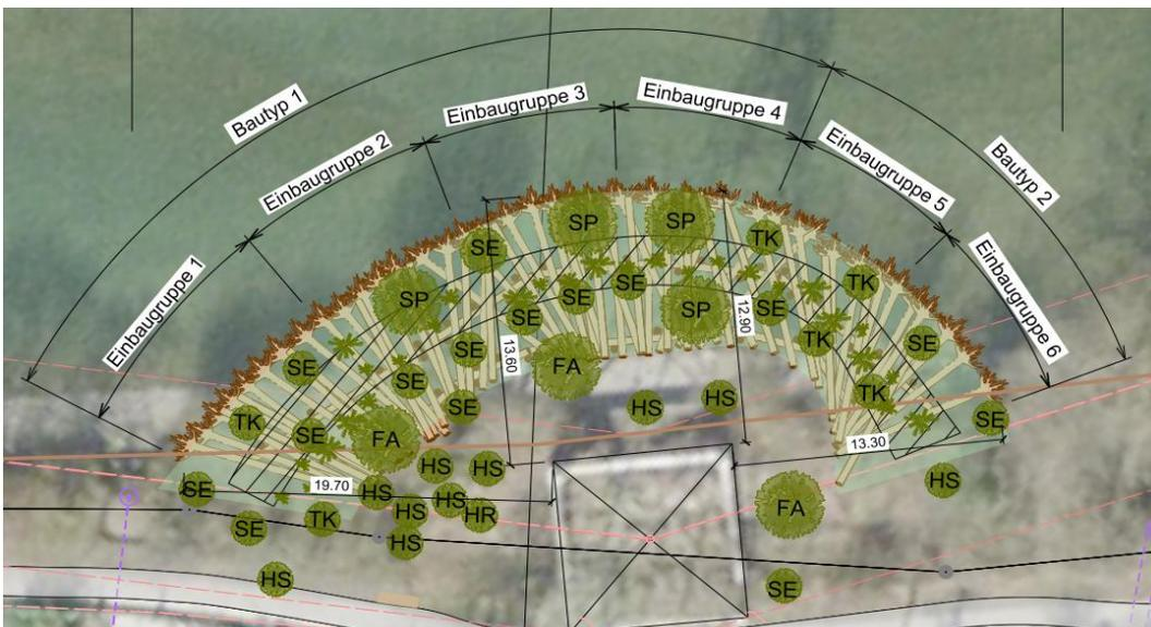
Abbildung 26 : Module des ELJ-Uferverbaus zu einer Kanzelform angeordnet, um einen Strommast (Hochspannungsleitung) vor Erosion zu schützen (Objektschutz). Beispiel: Aare in Bern (Löchligut).
