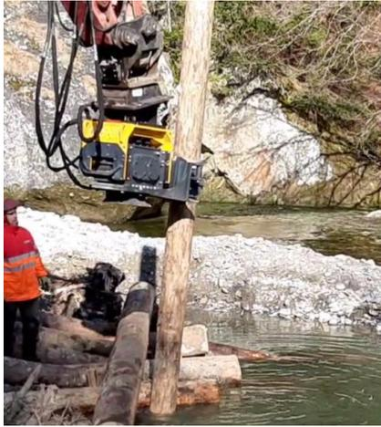
Abbildung 57: Umgebaute Vibroplatte mit Glockenkopf für Stammaufnahme und Greifer als Anbauwerkzeug an Hydraulikbagger.
