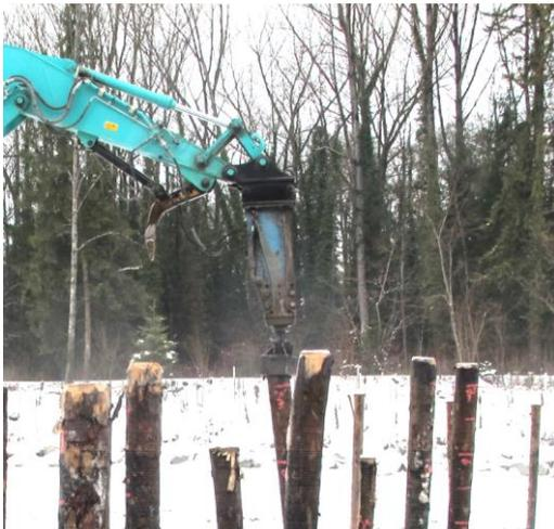
Abbildung 55: Umgebauter Abbauhammer mit Glockenaufnahme für Baumstämme als Anbauwerkzeug am Hydraulikbagger.
