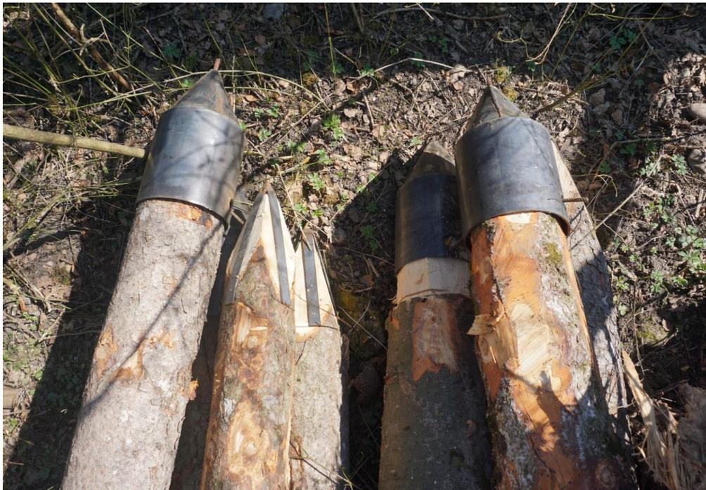
Abbildung 59: Baum-Pfähle mit Stahlspitzen: Vollmantelspitzen (für dicht gelagerten Kies und stark verwitterter Fels) empfohlen
