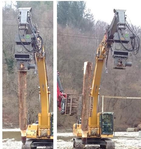
Abbildung 56: Vibro-Ramme mit Klemmaufnahme als Anbaugerät an Hydraulikbagger. Typ Oscar Meier AG.
