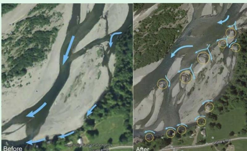
Abbildung 16 : Beispiel Akzentuierung / Wiederanbindung Nebenarme mit Inselkopf-ELJs am Upper Quinault River, Washington (Abbe, et al., 2018).
