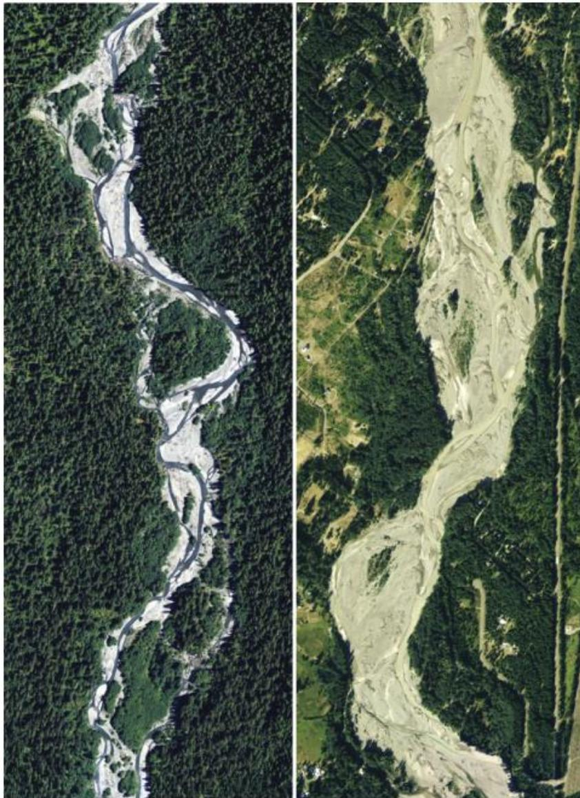
Abbildung 9 :Mögliche stabile Zustände eines Flusses; ohne Abholzung von grossen Uferbäumen (links) oder nach langjähriger Entnahme der grossen Uferbäume (rechts). Links: Hoh River, Washington, USA; Rechts: Cowlitz River, Washington, USA (Collins, et al., 2012).
