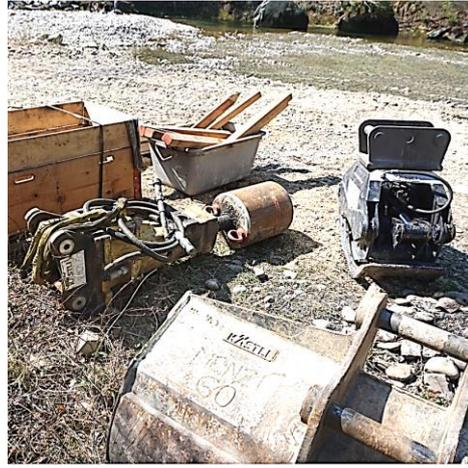
Abbildung 58: Detailfoto (umgebauter Abbauplatte mit Glockenaufnahme links, umgebaute Vibroplatte mit Glockenkopf rechts).
