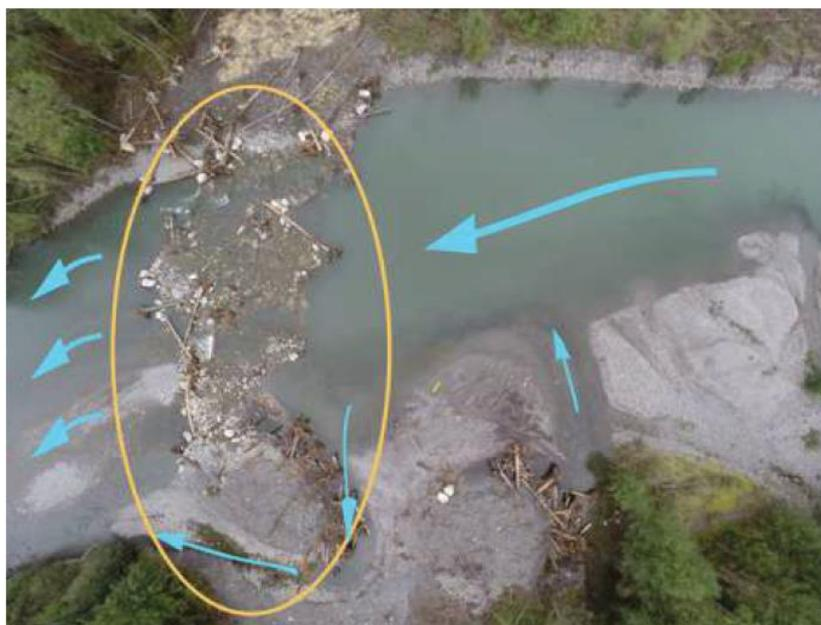
Abbildung 45 : Beispiel Fluss: Gerinnequerende ELJs zur Umkehr der Gerinnevertiefung am Upper South Fork Nooksack River, WA, USA (Abbe, et al., 2018)
